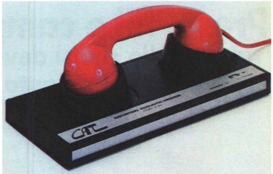
Un accoppiatore acustico: un tempo i modem non potevano essere collegati direttamente alla linea PSTN, per cui si utilizzava un apparecchio, costituito da un microfono ed un altoparlante, per il collegamento direttamente alla cornetta del telefono. La velocità di questo oggetto era di 300 Baud.
